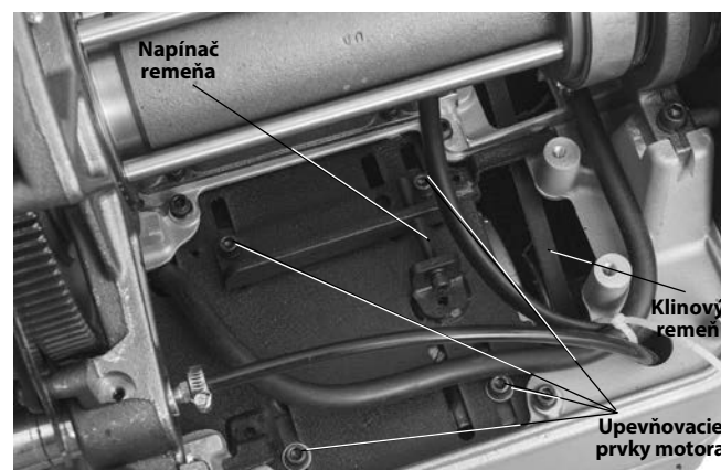
Obrázok 35 - Napínanie remeňa
