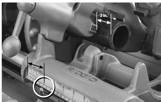
Εικόνα 20Β – Δείκτης μετρητή μήκους στο επιθυμητό μήκος
