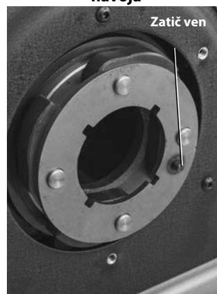
Slika 25B - Zadnja opora obračalnega droga - nameščanje zatiča
