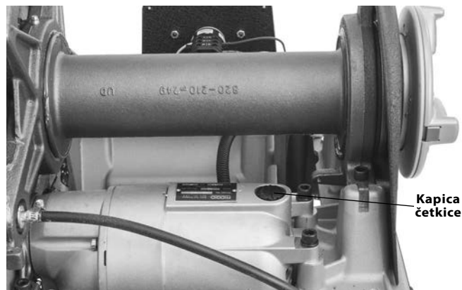
Slika 34 - Skidanje poklopca motora/zamjena četkica
