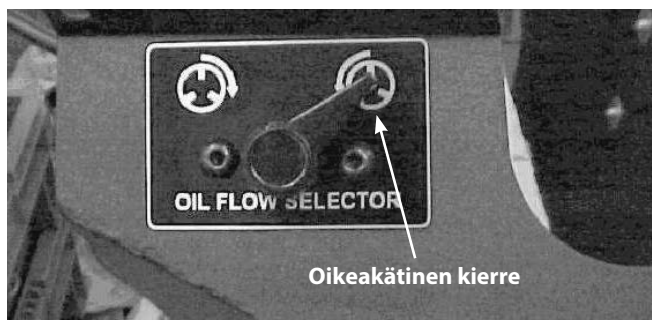
Kuva 24 – Öljyvirtauksen valitsin vasen- ja oikeakätiselle kierteelle
