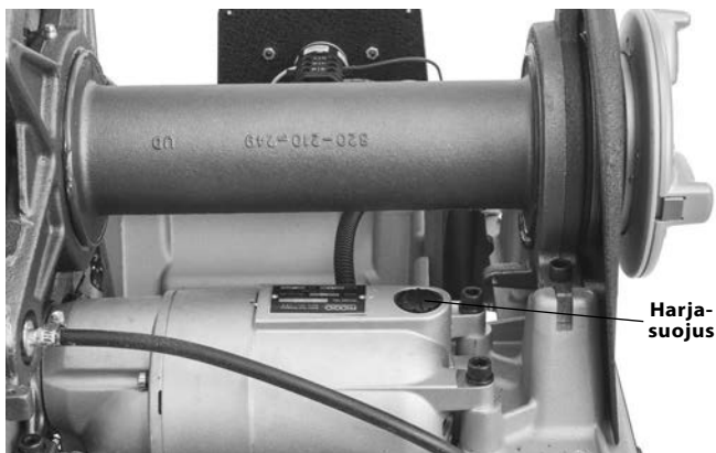
Kuva 34 – Moottorin kannen irrotus / harjojen vaihto
