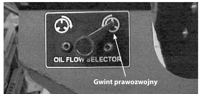
Rysunek 24 – Przełącznik wyboru obiegu oleju W LEWO lub W PRAWO
