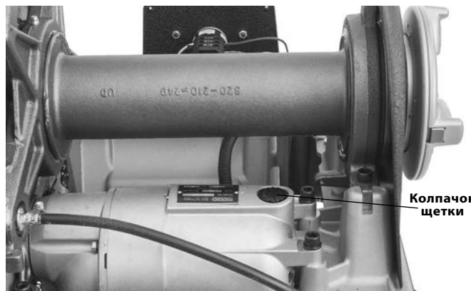
Рис. 34 – Снятие крышки электродвигателя/ замена щеток
