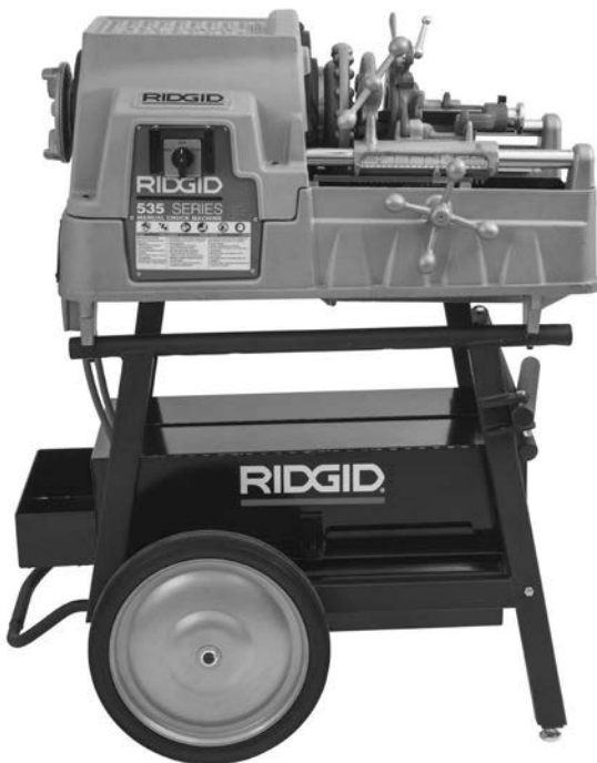
Slika 28 – Mašina spremna za transport
