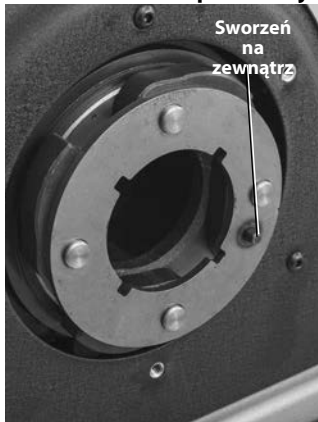
Rysunek 25B – Tylny wspornik obrotowy pręta – wkładanie sworznia
