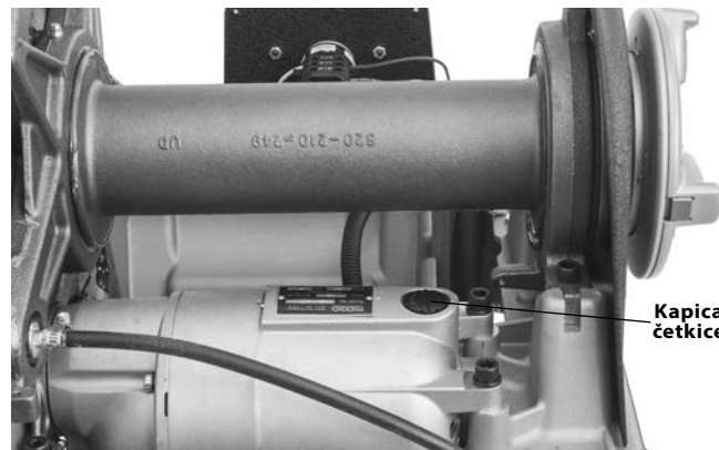
Slika 34 – Skidanje poklopca motora/promena četkica
