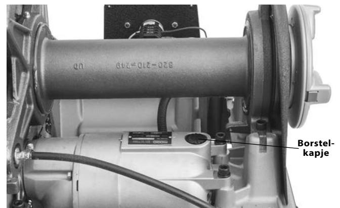
Figuur 34 – Verwijderen van de machinekap / vervangen van de borstels
