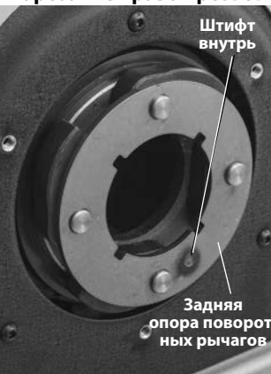
Рис. 25В – Задняя опора поворотных рычагов - место расположения штифта
