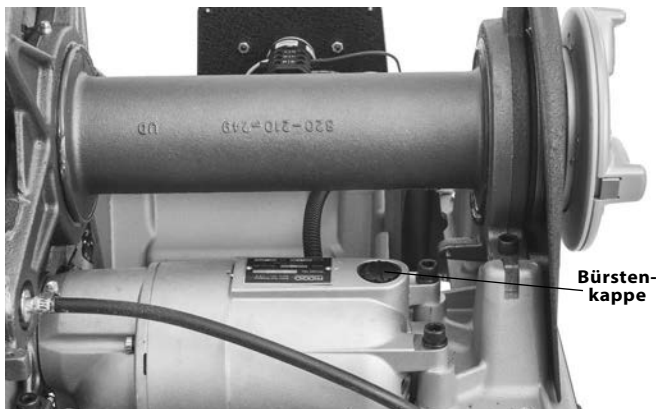
Abbildung 34 – Ausbau der Motorenabdeckung/Austausch der Bürsten
