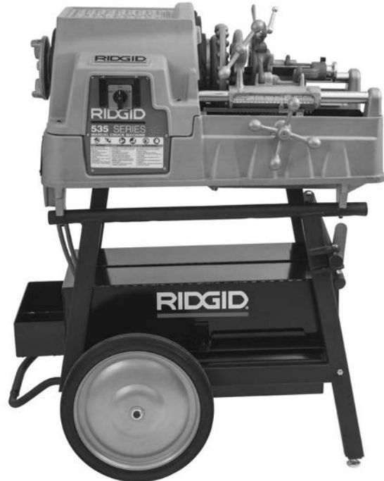
Kuva 28 – Kuljetusta varten valmisteltu kone
