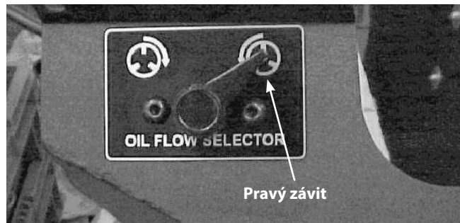
Obrázok 24 – Volič ľavého alebo pravého prúdenia oleja
