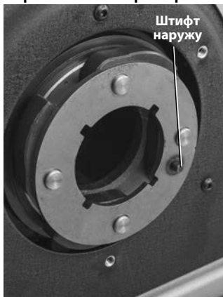
Рис. 25В – Задняя опора поворотных рычагов - место расположения штифта
