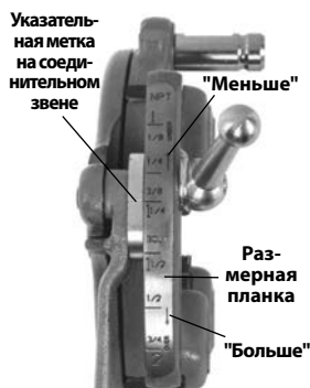
Рис. 7 – Настройка размера резьбы
