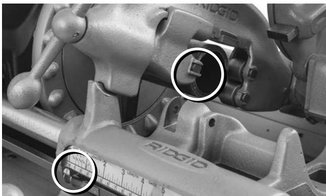
Kuva 20A – Leikkuuterä putken päätä vasten Aseta osoitin nollaan (0)
