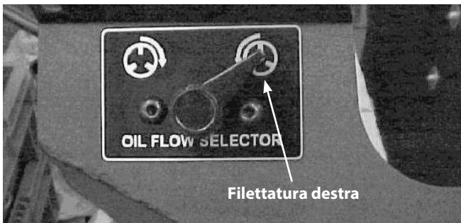
Figura 24 – Selettore del flusso dell'olio sinistro o destro
