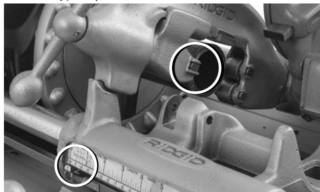
Obrázok 20A – čepel kolieska rezáka na konci rúry. Nastavte ukazovateľ na nulu (0)
