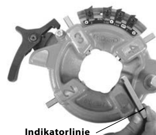
Figur 14 – Isättning av backar
