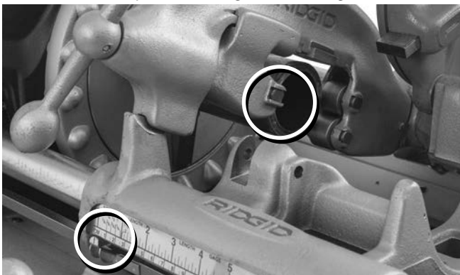
Figure 20A – Lama a ruota della cesoia contro l'estremità del tubo. Impostare il puntatore sullo zero (0)
