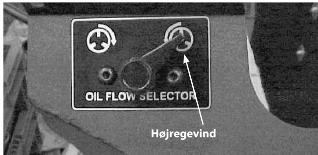
Figur 24 – Vælger for olieflow til venstre eller højre
