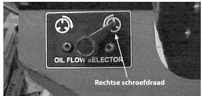
Figuur 24 – Keuzeschakelaar oliestroom links/rechts
