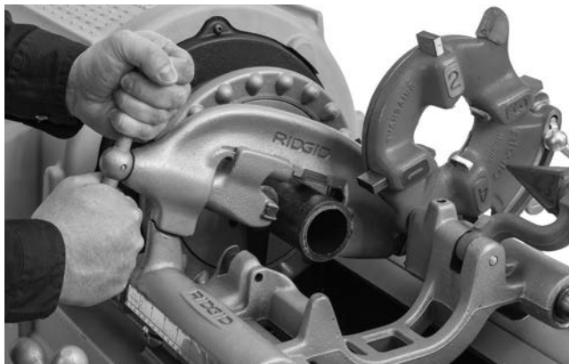
Figure 21 – Coupe-tube en marche
