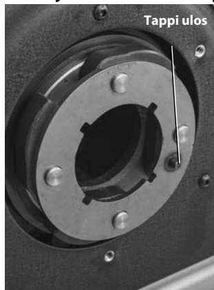
Kuva 25B – Takatapin tuki - Tapin sijainti
