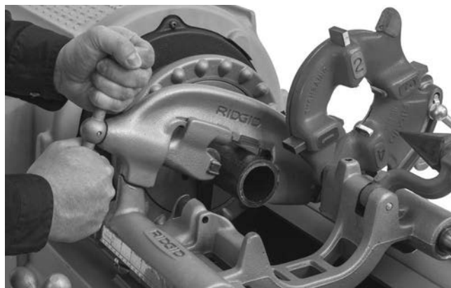
Figura 21 – Taglio del tubo con la cesoia
