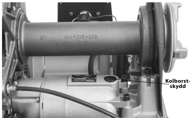
Figur 34 – Byte av motorkåpa/kolborstar
