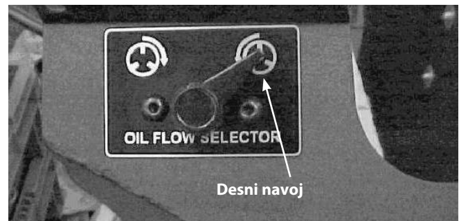
Slika 24 – Selektor toka ulja za LN ili DN
