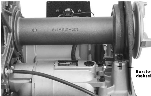
Figur 34 – Afmontering af motordæksel/udskiftning af børster
